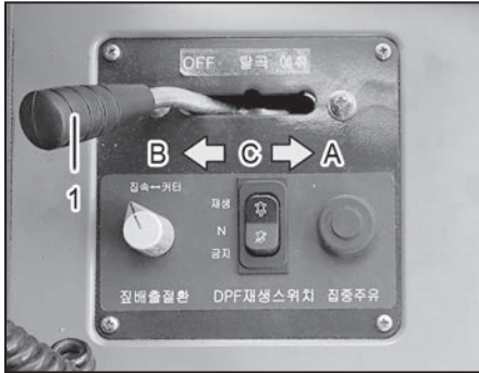
(1) 파워 클러치 레버 (A) 예취부 작동 「ON」 (B) 정지 「OFF」 (C) 탈곡부 작동
