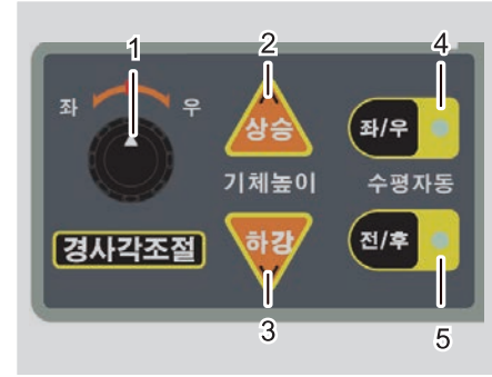
(1) 좌우 수평 조절 다이얼 (2) 기체높이 상승 스위치 (3) 기체높이 하강 스위치 (4) 좌/우 수평 자동 스위치 (5) 전/후 수평 자동 스위치
