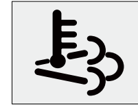
EGT warning lamp
